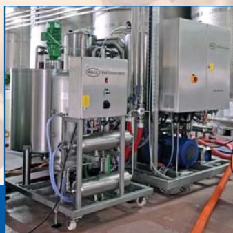
Figura 1: Plataforma de dosificación Oenofine XL
